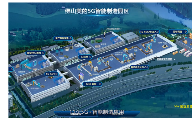
▲ 美的 5G 智能工厂全景图。园区内部署了 2 万 + 数据收集点，融合多种技术打造 5G+UPF+MEC 网络方案，落地 11 个 5G+ 工业和网络应用场景
